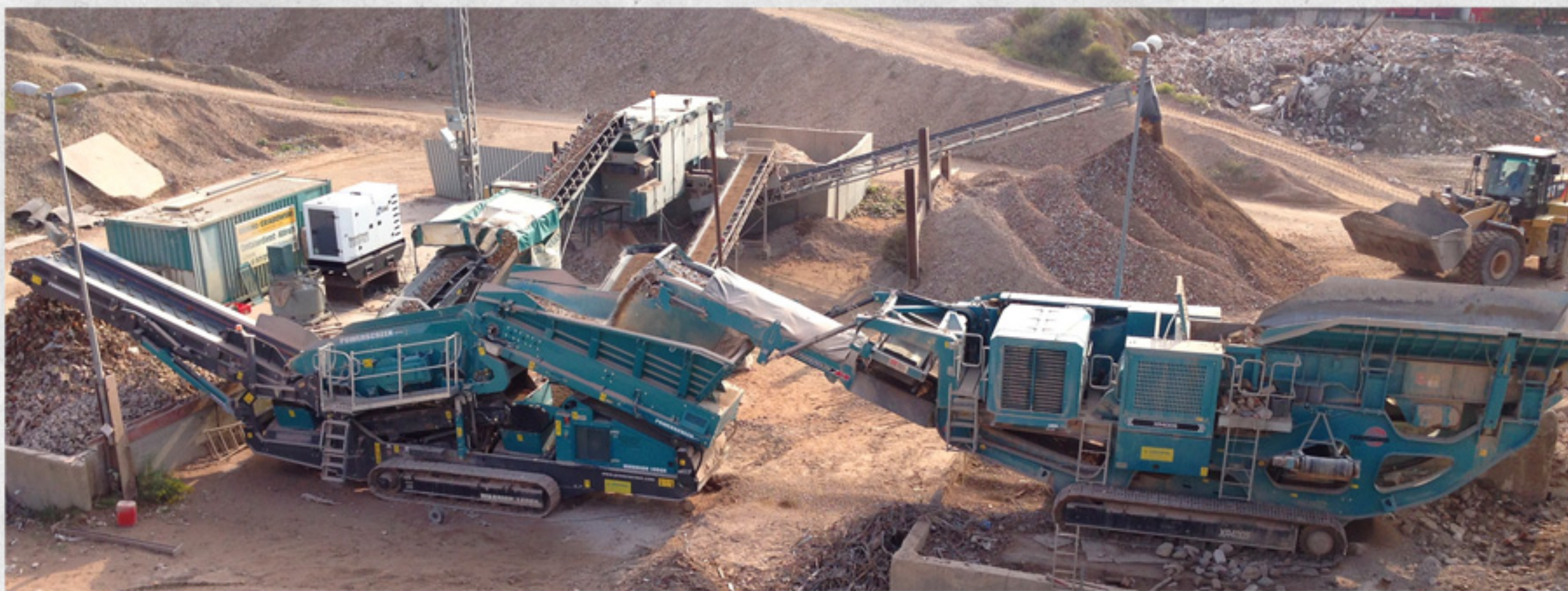
Kennzeichnend für die neue Backenbrecher-Reihe ist der dieselsparende Antrieb über einen Scania-Motor.
